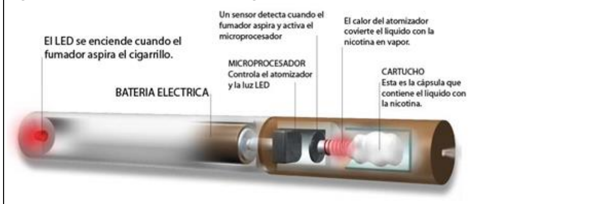
Figura 1: Elementos básicos del cigarrillo electrónico
